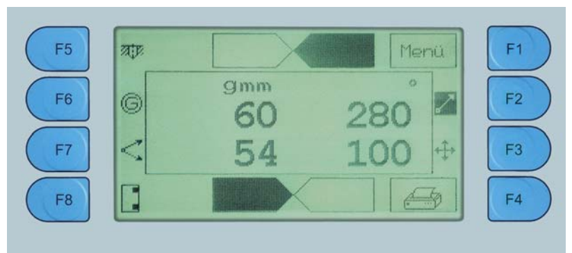
Индикация данных дисбаланса и «Двойная Стрелка» подрезная поддержка Выбор способа индикации и печать протокола функциональными клавишами
