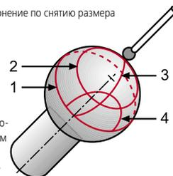
Предельное значение отклонения по измерению формы
