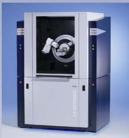
**Рентгеновские дифрактометры** - для качественного и количественного анализа кристаллической фазы, разориентации кристаллита, остаточных напряжений.
