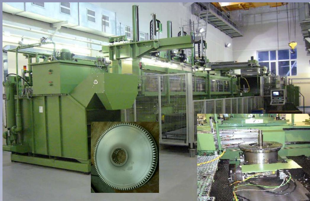
Технология протягивания пазов турбинных и компрессорных дисков на вертикальном протяжном станке **HOFFMANN RASMX 25 x 2750 x 400** на НПК «ЗОРЯ-МАШПРОЕКТ»
