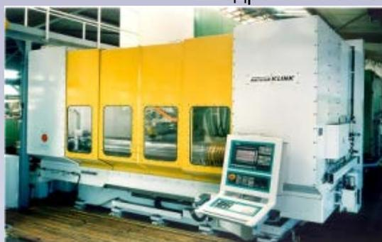
В комплекс входят: - станок **Arthur Klink RSB 1600** для шлифования и заточки всех режущих и вспомогательных кромок протяжки;
