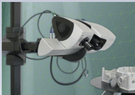
**Мобильные оптические и лазерные установки** для высокоточного оперативного контроля сложных поверхностей и форм. Работа с 3D CAD моделями. Точность от 10 мкм. Контроль деталей и поверхностей, касание с которыми недопустимо в связи с их возможной деформацией. Оптический контроль статических деформаций.
